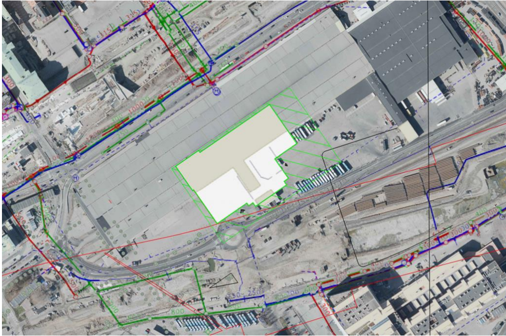
Figuren illustrerar föreslaget läge för Centralbadhus överlagrat befintligt VA-ledningsnät. Streckad blå dricksvattenledning i konflikt med byggnad är en privat ledning som inte tillhör det allmänna VA-ledningsnätet. Kan enligt uppgifter vara slopad.
